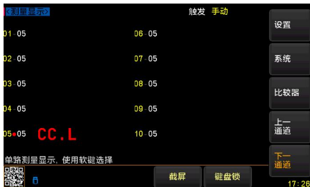
图 5-4 LOW (-) 端测试线接触不良
