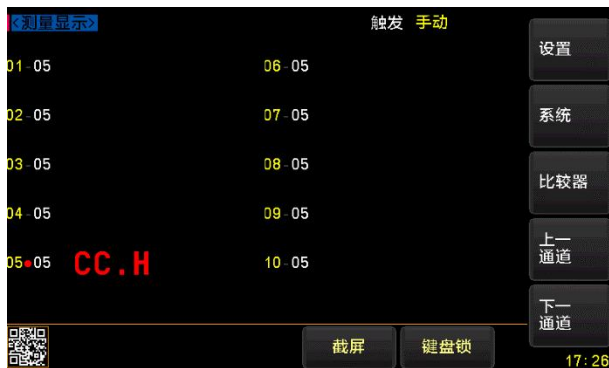
图 5-3 HIGH (+) 端测试线接触不良
