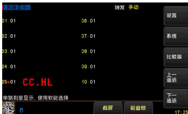
图 5-2 测试线全部接触不良
