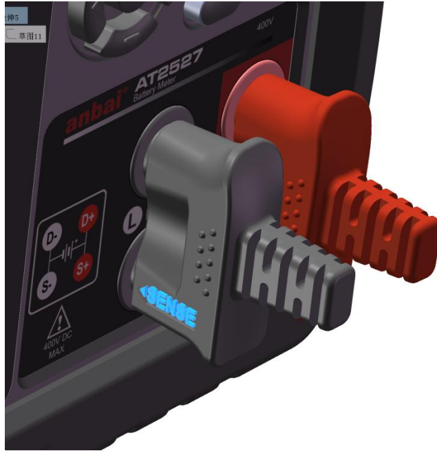
测试线的连接方法
